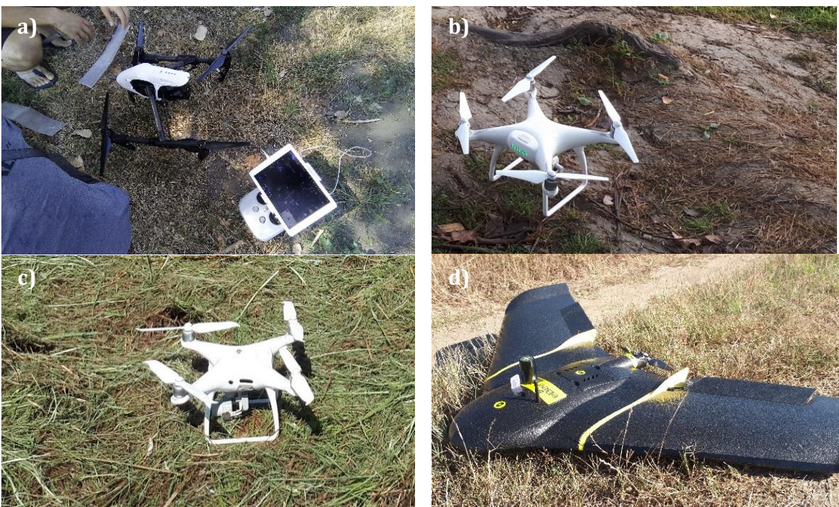
Slika 3.14. Različite vrste bespilotnih letelica korištene za prikupljanje aerofotografija makrofita: a) Inspire 1 , b) Phantom 4 , c) Phantom 4 PRO , d) eBee Sensefly
